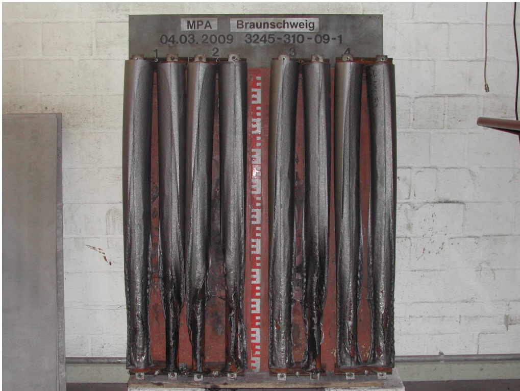
Ansicht des Produkts „Climaflex 48-20“ nach dem Brandschachtversuch
