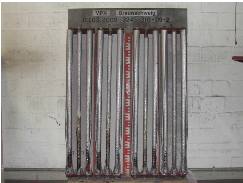
Ansicht des Produkts "Bernerflexflex 13-28" nach dem Brandschachtversuch
