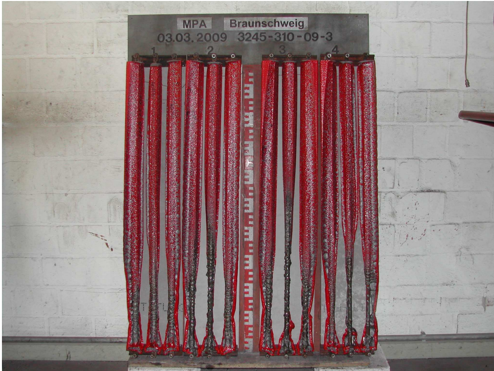
Ansicht des Produkts "Exzentroflex 12/15-25" nach dem Brandschachtversuch
